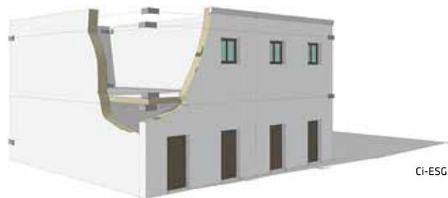
**Fig. 115 .** Sistema de travamento perimetral Perimeter locking system
